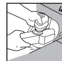
быть предусмотрены на этапе монтажа, для предотвращения повреждения элементов системы при нарезке деформационных швов. Так же необходимо прорезать деформационные швы в проемах, разделяющие разные помещения, во избежание образования трещин. Деформационные швы рекомендовано выполнять глубиной, равной не менее, чем половина толщины наносимого слоя. Перед укладкой напольного декоративного покрытия прорезанные швы рекомендуется заполнить подходящим герметиком.
